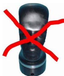
Prüfkopf zu wenig aufgeblasen
