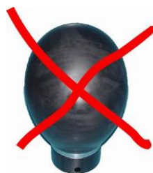
Prüfkopf zu stark aufgeblasen.
